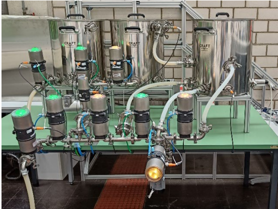
Abb. 1: Experimentelle Brauanlage mit pneumatisch gesteuerten Ventilen, Ultraschallsensoren zur Füllstandsmessung und SPS-Steuerung; Touchscreen nicht abgebildet.
