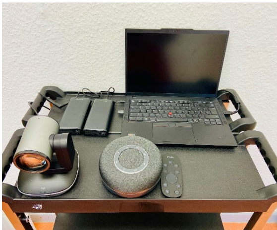
Abb. 5: Aufbau eines PTZ-Systems auf einen mobilen Tisch.
