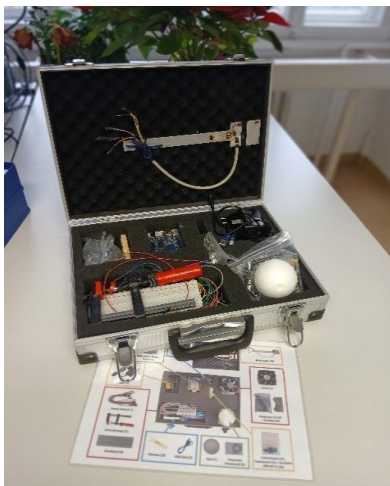
Abbildung 3: Experimentierkoffer mit dem Arduino, Sensoren, Stellgliedern und Kabeln (aktueller Inhalt)
