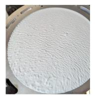
Abb. 6: Vliesschicht nach Beenden des Abscheideprozesses
