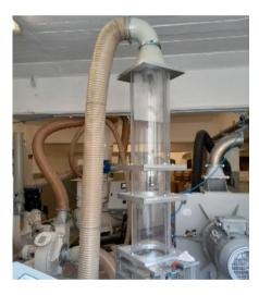
Abb. 5: Versuchsaufbau zur Herstellung von Papiervlies
