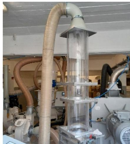
Abb. 5: Versuchsaufbau zur Herstellung von Papiervlies
