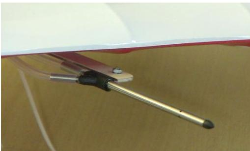
Abb. 9: Prandtl-Rohr aus dem Modellbaubedarf zur Abnahme von statischem und Gesamtdruck vor der Flügelnase
