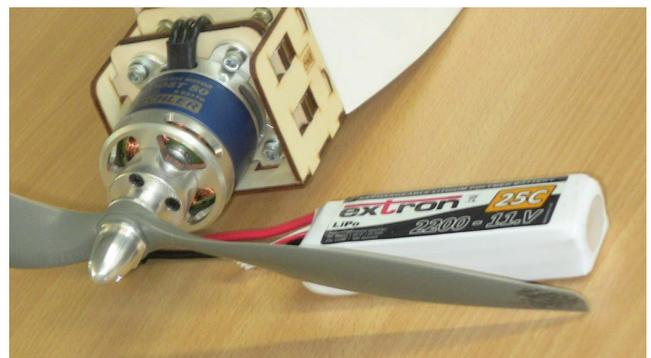
Abb. 6: Motor, Propeller und Flugakku aus dem gehobenen Modellbauzubehör-Sortiment
