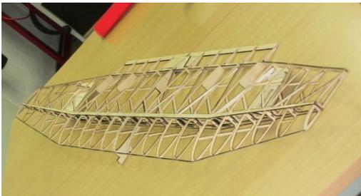
Abb. 7: Holm-Rippen-Struktur des Flügels für das Referenz-sUAS.
