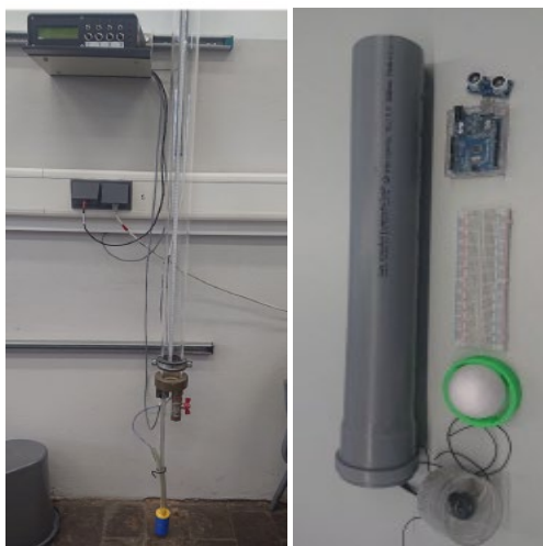
Abbildung 4: Ursprünglicher Regelkreisversuch (Tauchpumpe) (l.) und Komponenten des ersten Prototyps Regelkreis für das Praktika@Home (r.) [5]
